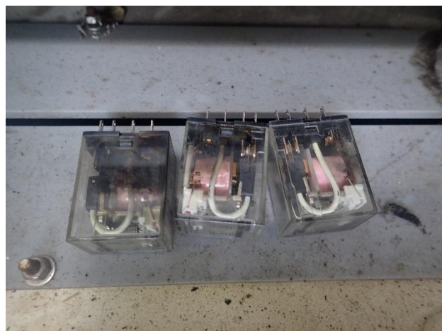
数カ所のリレースイッチが焦げ付いている
