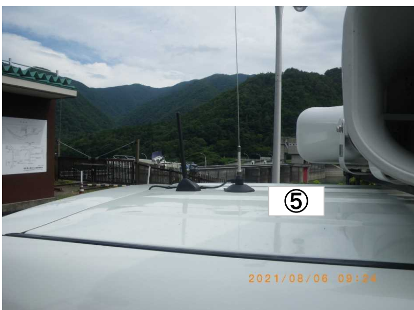
⑤車載用防災無線機アンテナ
