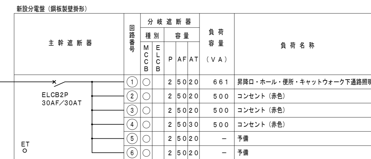
新設分電盤単線結線図 (1L-2)
