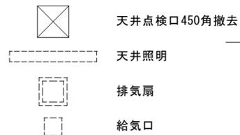
破線表示：設備工事撤去
